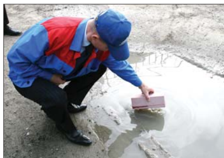
Главный инженер ООО «Силикатстрой» Д.Н. Ражев демонстрирует качество гидрофобизированного кирпича в наиболее жестких условиях
